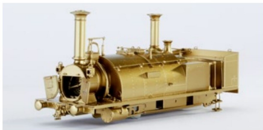
Satteltanklok mit Kondenskamin der Lausanne-Fribourg-Bern-Bahn (LFB).
