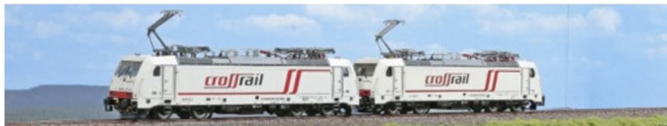
Die Crossrail-Loks BR 186 kommen exklusiv für die Schweiz im Doppelpack mit Dummy und angetriebener Lok.
