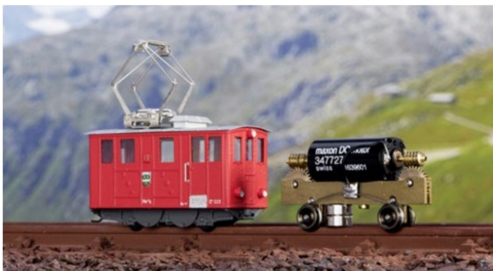
Für die ursprünglich nur rollfähig angebotenen SPB hat AB-Modell nun einen Antrieb entwickelt.
