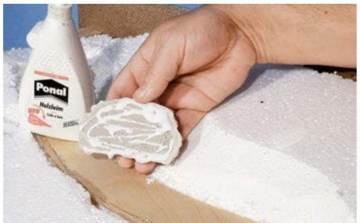
Die Auflagerfläche erhält einen Ponalschicht.
