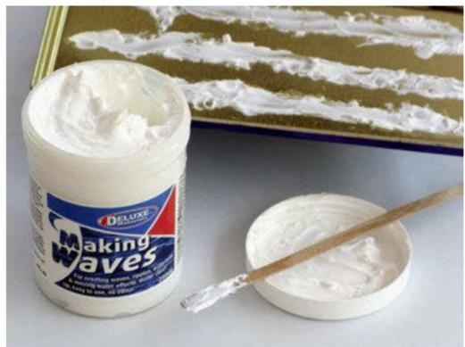
Deluxe Materials Making Waves ist eine dickflüssige milchige Masse, die mit einem Holzstäbchen geformt werden kann, wenn die Masse noch feucht ist. Nach dem Trocknen ist sie durchsichtig.
