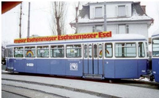
Eine weitere Ausnahme: Der B 4 799 (Serie 799–801) aus dem Jahre 1973, Wagenkasten von FFA, Innenlagerdrehgestelle von SWP, nach Basler Vorbild, wieder mit zwei Türen.
