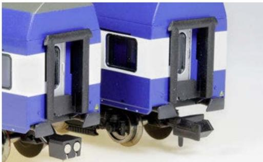
Die Doppelstockwagen mit der PEHO-Kupplung (links) und der Original ...
