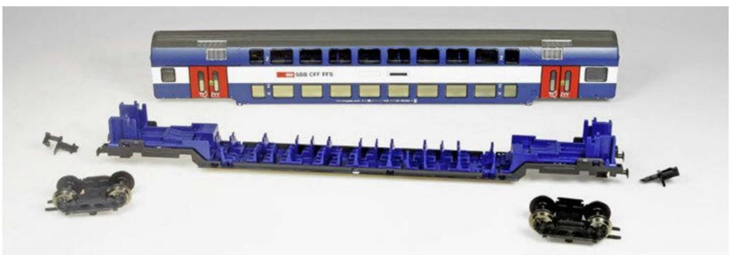
Dank priffig gemacht Klipp- und Rastverbindungen geschieht die Zerlegung der Fleischmann Wagen ohne grossen Aufwand und Werkzeug.
