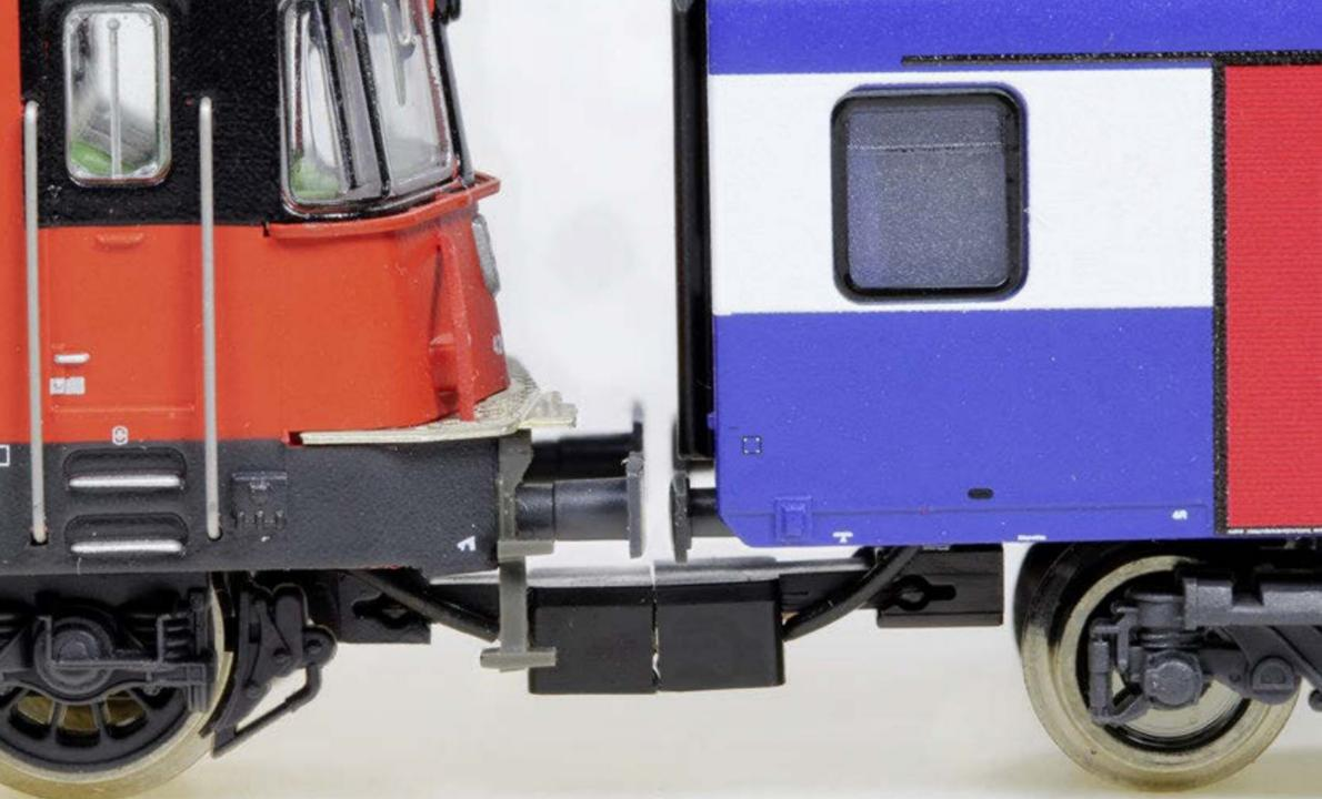
Die magnetischen sowie elektrisch leitenden Kurzkupplungsköpfe von PEHO als verbindendes Element zwischen den Loks und den Wagen des HVZ.
