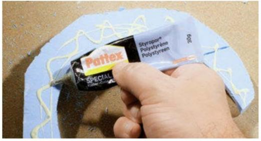
Mit Styropor-Kontaktkleber wird das Modell montiert.
