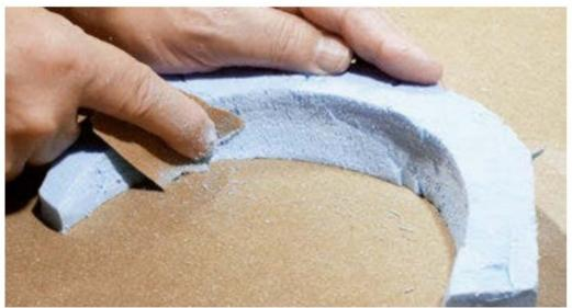
Mit grobem Schleifpapier kommt das Bahnprofil in den Kurvenkörper.
