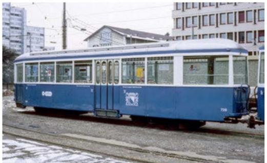
Das modernisierte Original mit den neuen Falttüren ist hier durch B 728 vertreten. Der Anhänger ist mit Innenlagerdrehgestellen sowie Torsionsstabfederung ausgestattet.
