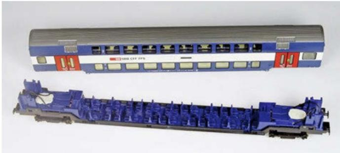
Nach einem ersten Funktionstest kann der Doppelstockwagen wieder zusammengebaut werden.
