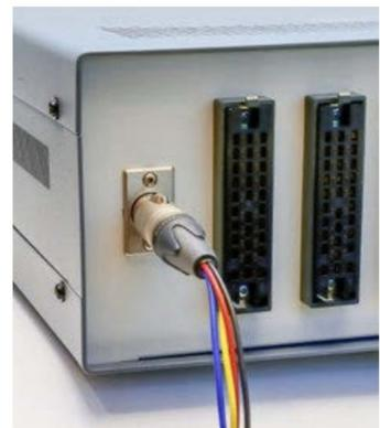
Eine XLR Steckverbindung (nicht eingesteckt) zur Stromversorgung von Elektronikgruppen.
