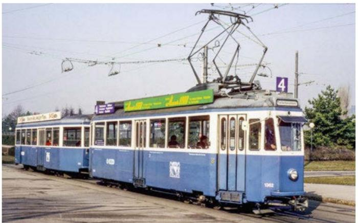
Auf den ersten Blick erkennbar waren die Fahrzeuge mit Außenrahmendrehgestellen an der Aussparung beim vorderen Drehgestell der Türenseite. Hier Be 4/4 1362 beim Sportplatz Hardturm am 26.2.1992.
