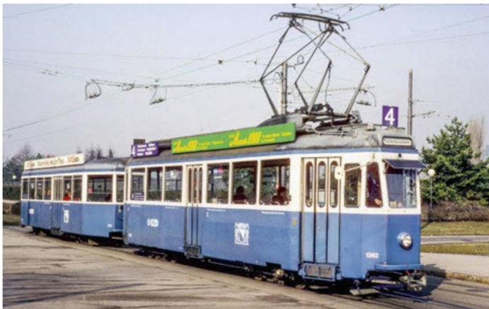
Auf den ersten Blick erkennbar waren die Fahrzeuge mit Aussenrahmendrehestellen an der Aussparung beim vorderen Drehgestell der Türeenseite. Hier Be 4/4 1362 beim Sportplatz Hardturm am 26.2.1992.
