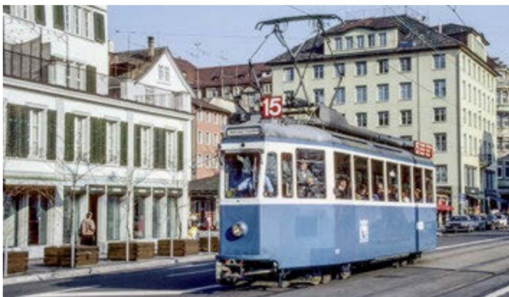
Ausnahmsweise ist Be 4/4 1375 auf der Linie 15 als Alleinläufer unterwegs und nimmt den Platz eines Pedalers ein. Sichtbar sind die Innenlagerdrehgestelle.
