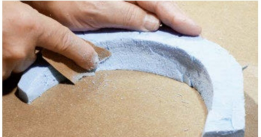
Mit grobem Schleifpapier kommt das Bahnprofil in den Kurvenkörper.
