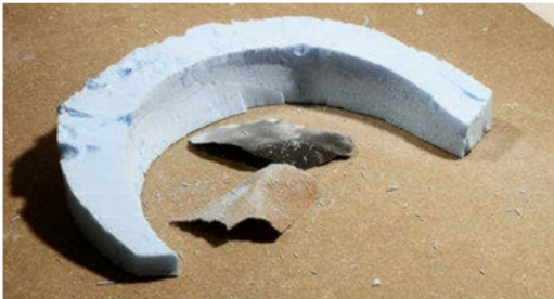
Feinere Körnung dient dem abschliessenden Glätten der Bahn.
