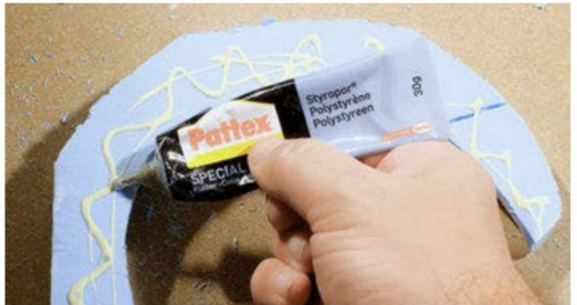
Mit Styropor-Kontaktkleber wird das Modell montiert.
