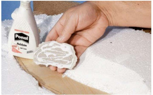
Die Auflagefläche erhält einen Ponalschicht.
