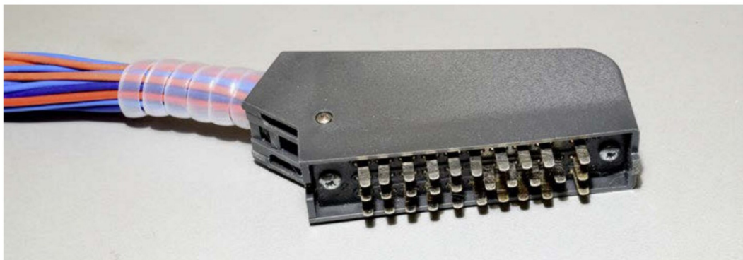
Eine für den Modellbahneinsatz fertig bestückte 30-polige RP 622 Steckverbindung.
