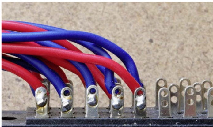
Der 30-polige RP 622 Stecker in der Bearbeitungsphase.
