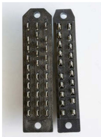
Die Unsymmetrie der Kontaktanordnungen ist Garant für ungewollten Verpolungsschutz.
