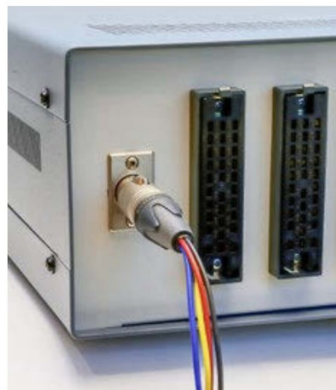
Eine XLR Steckverbindung (nicht eingesteckt) zur Stromversorgung von Elektronikgruppen.
