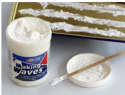
Deluxe Materials Making Waves ist eine dickflüssige milchige Masse, die mit einem Holzstäbchen geformt werden kann, wenn die Masse noch feucht ist. Nach dem Trocknen ist sie durchsichtig.
