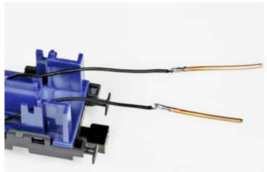
... und mit einem ca. 12 mm langen Stück Kupferdraht (0,75 mm²) verlötet.
