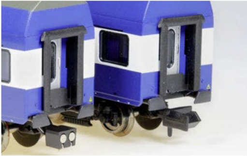
Die Doppelstockwagen mit der PEHO-Kupplung (links) und der Original...
