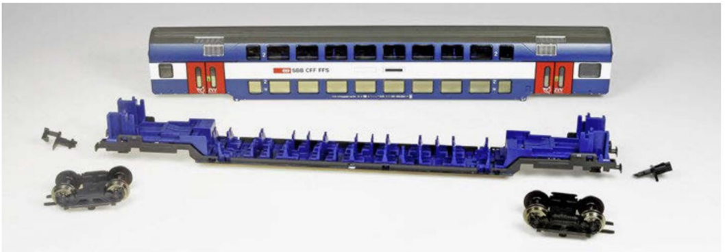
Dank pfiffig gemachter Klipp- und Rastverbindungen geschieht die Zerlegung der Fleischmann Wagen ohne grossen Aufwand und Werkzeug.
