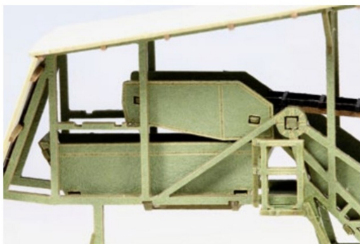
... wie die Sortiersiebe zur Trennung der Rüben von Steinen und Erde.
