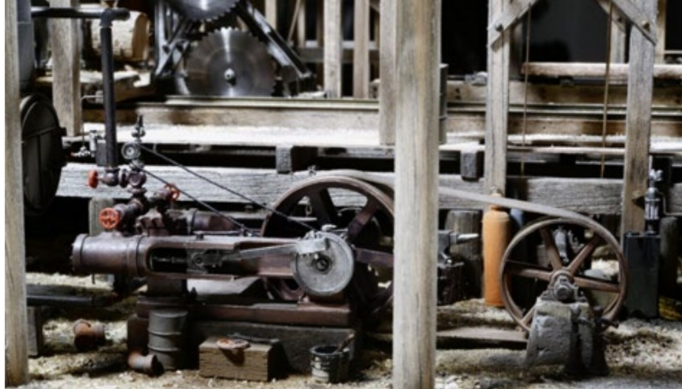
Ohne den Antrieb ginge gar nichts. Die Triebkraft wird über Transmissionen auf die Maschinen geleitet.
