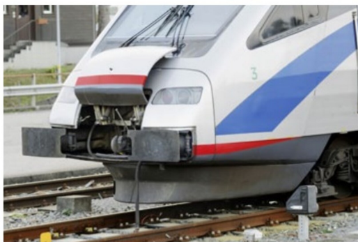
Die klassische Kupplung wurde für Vorspann und zum Abschieben oft genutzt.
