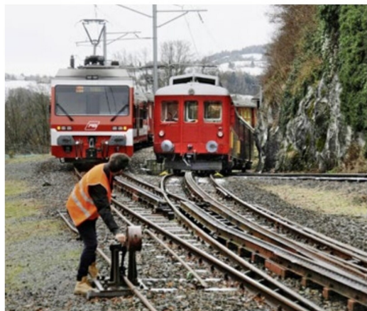
Im Jahr 2015 eine bahntechnische Rarität: Zugskreuzung in Wienacht-Tobel über eine handbetriebene Riggensbachsche Zahnstangenweiche.
