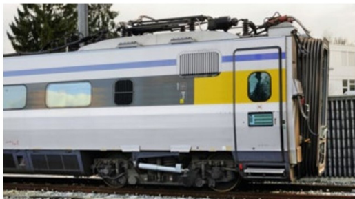
Das Wagenende mit Pantograph nach Schweizer Norm.
