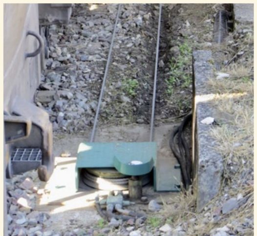
Die Umlenkrolle des Wagnenvortriebes auf der anderen Seite.
