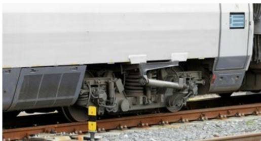
Innovative Technik: Drehgestell mit Neigetechnik.
