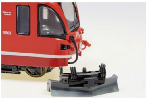
Erster Schritt für die Demontage ist das Ausklippen des Schienenräumers.
