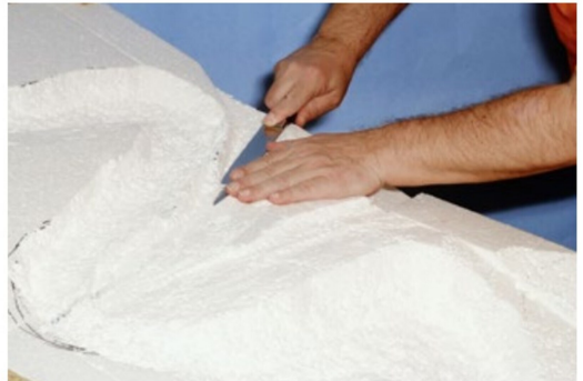
... Messer und flach geführter, langer Klinge die Kontur herausgearbeitet.
