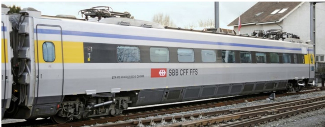
Wagen ETR 470 93 85 0470 503-0 CH-SBB mit Pantographen für Deutschland (links) und die Schweiz.
