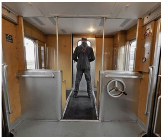
Plattform des B 10 als Führerstand für den mit Funk und Fernsteuerung ausgerüsteten Lokführer.
