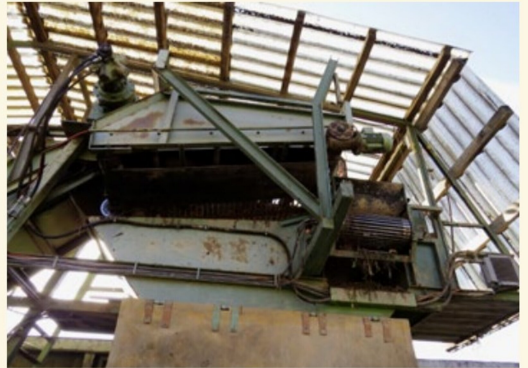
Hier werden die Zuckerrüben von Steinen, Unkraut und Humus getrennt.
