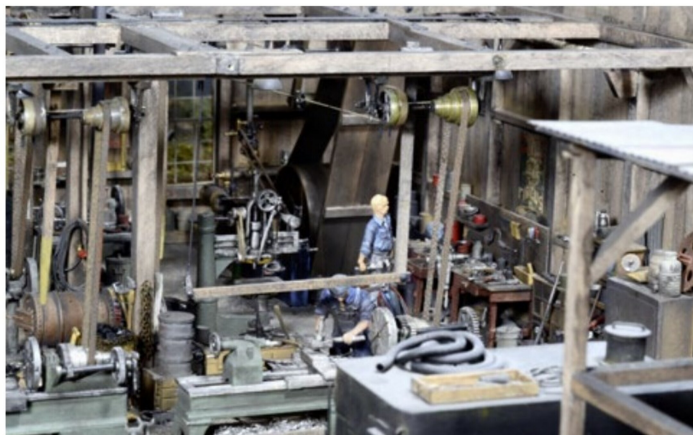
Die Lederriemen der beeindruckenden Transmissionen bestehen aus 0.2 Millimeter dünnem Leder.
