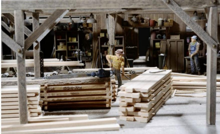
Die zugeschnittenen Bretter werden für den Abtransport gestappelt. Für den Transport steht ein spezielles Fahrzeug zur Verfügung, so eine Art Mischung aus Gabelstappler und Traktor.
