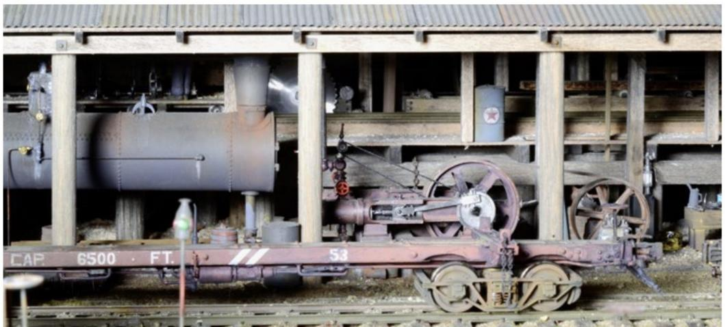
Zu Beginn wurden die Maschinen noch durch Dampf angetrieben. Der Kessel für die Dampferzeugung war deshalb oft in der Sägerei untergebracht.
