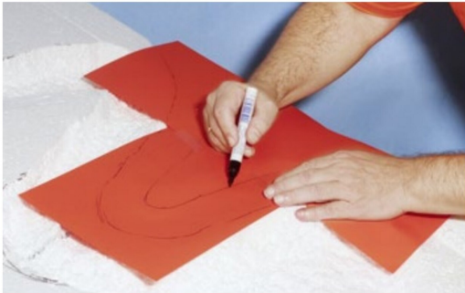
Für den Zuschnitt der Strassenplatte entsteht eine Schablone, deren ...
