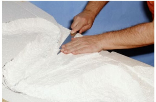
... Messer und flach geführter, langer Klinge die Kontur herausgearbeitet.
