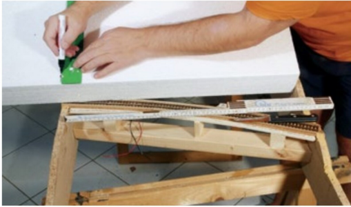
Mit der Reisschiene kann im rechten Winkel angezeichnet werden.
