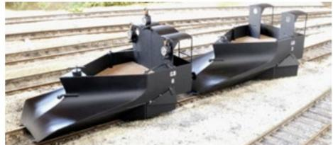
1882 beschaffte die Gotthardbahn Fahrzeuge dieses Typs. Der Schnee konnte über das Profilmass hinaus auf 4 Meter Breite geräumt werden, indem zwei seitlich angebrachte Bleche herausgeschwenkt wurden. Anfänglich musste sich das Personal mit zwei schmalen Schutzwänden mit kurzem Dächlein begnügen. Zu einem späteren Zeitpunkt wurde zwischen die Schutzwände eine Doppeltür mit ebenfalls einem Verbindungsdeck gebaut. Die Tür ermöglichte den
