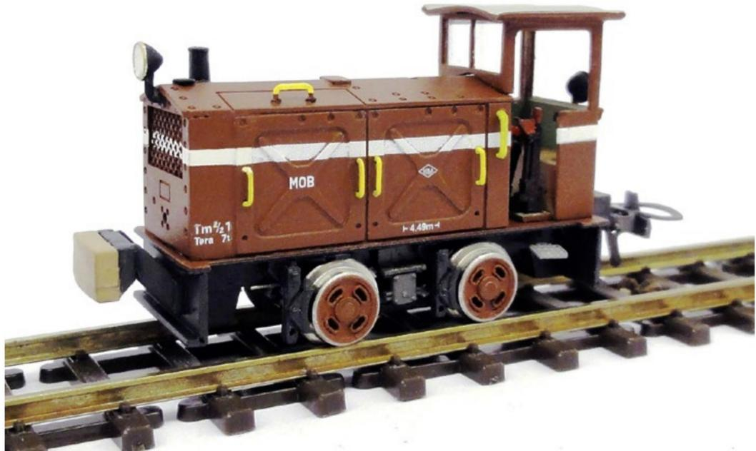
1926 wurde im Wallis mit dem Bau der ersten Dixence-Staumauer im Val d'Hérémence begonnen. Zur Unterstützung dieser Bauarbeiten wurde unter anderem am 3. September 1931 eine kleine Baulok in Betrieb genommen: Orenstein & Koppel, Produktions-Nr. 20220. Gewicht: 7 t, Vmax: 7 Km/h, 2-Zylinder Diesel, Kettenantrieb und kleine halboffene Kabine für sitzende Bedienung.
