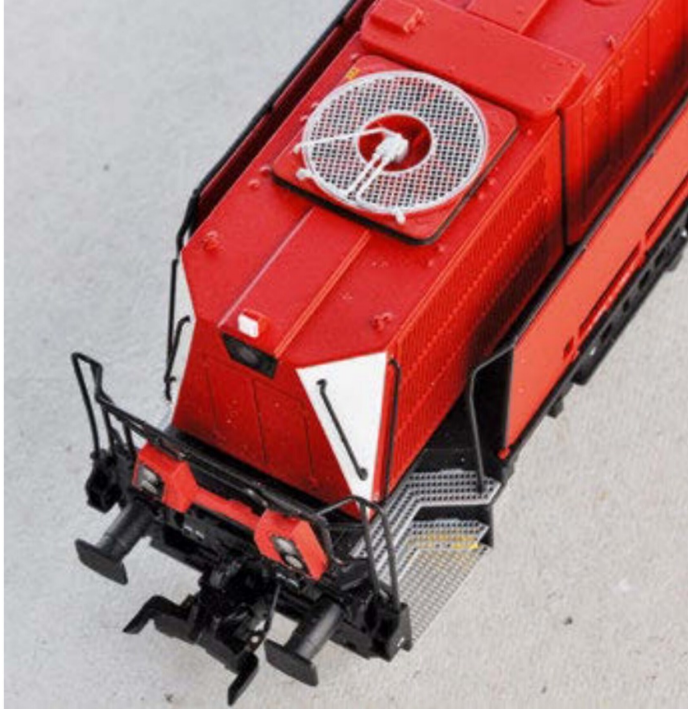
Fein gestaltetes und durchbrochen ausgeführtes Lüftergitter. Darunter sitzt der Lautsprecher.
