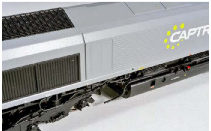
Bild 19 Nur bei extremer Kurvenfahrt fällt die Unterbrechung der Sandschläuche auf.
