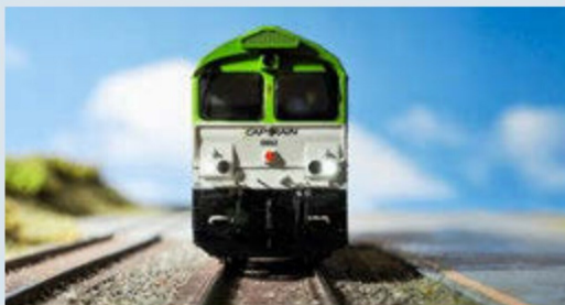
Bilder 21 + 22 Stirnbeleuchtung links für Deutschland und die Niederlande. Nur zwei Lampen sind in Belgien einzuschalten.
