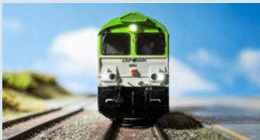
Bilder 21 + 22 Stirnbeleuchtung links für Deutschland und die Niederlande. Nur zwei Lampen sind in Belgien einzuschalten.
