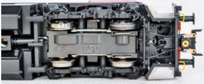
Die beiden Metallbügel bei der rechten Achse sorgen für das Quietschen beim Überfahren von Weichen.
