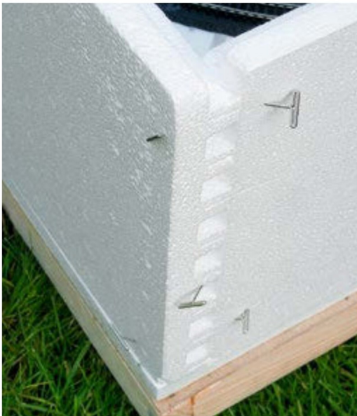
An den Ecken können die Woodland-Teile zusammen geklebt werden und während des Trocknens mit Woodland-Nadeln festgehalten werden.
