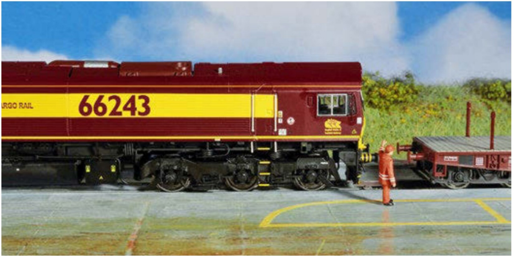
Bild 20 Im Gegensatz zur «Captrain»-Lokomotive hat die «ECR» einen Warnanstrich an den Einstiegsleitern.
