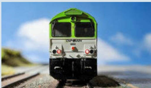
Bilder 27 + 28 Mit der Schlussbeleuchtung sind bei der «ECR»-Lokomotive pro Front allein 7 SMD-LEDs verbaut worden.
