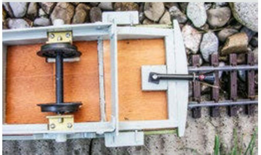
Wichtige Teile im Fahrgestell sind die einfache Achshalterung und die Trompetenkupplung, beides aus der eigenen Werkstatt.
