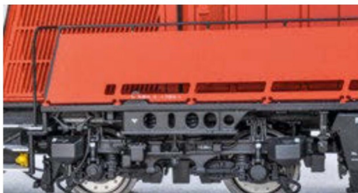
Feinste Drehgestellnachbildung am ESU-Modell. Selbst die Anschrift des Achsstandes auf dem Rahmen ist (von den meisten) ohne Lupe lesbar.
