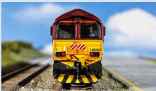
Bilder 27 + 28 Mit der Schlussbeleuchtung sind bei der «ECR»-Lokomotive pro Front allein 7 SMD-LEDs verbaut worden.
