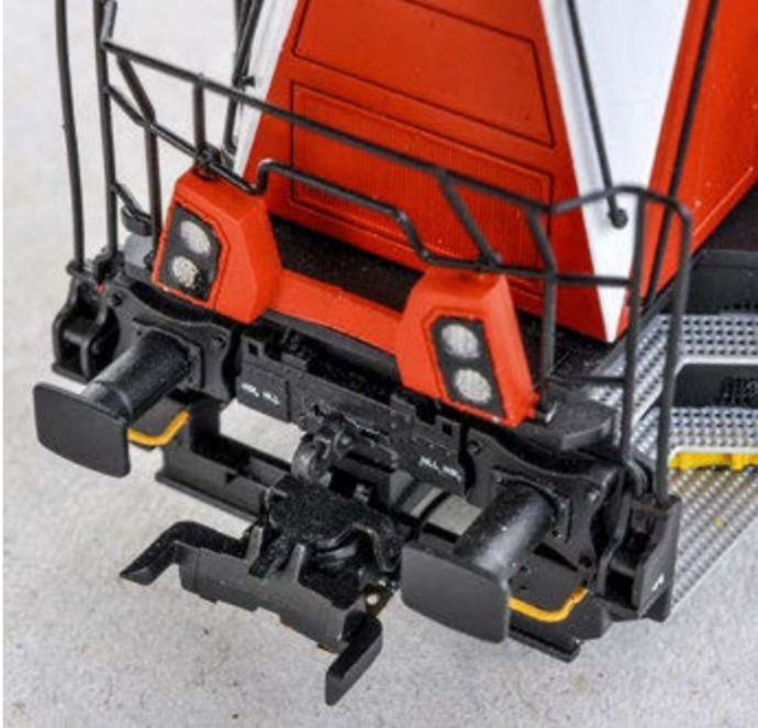
Mit der fernbedienbaren Rangierkupplung können die Modellwagen überall von der Lok getrennt werden.
