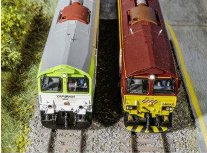
Bild 11 Die Zugfunkantennen befinden sich an unterschiedlichen Positionen.
