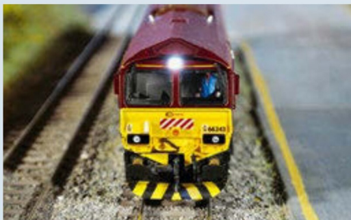
Bilder 25 + 26 Das Nothaltssignal der «ECR»-Lokomotive beweist es: Die aussenliegenden Scheinwerfer sind getrennt beleuchtet.
