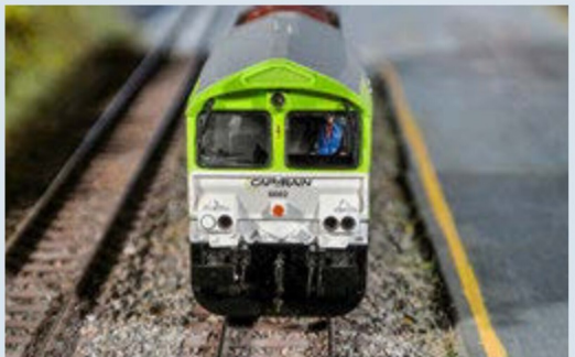
Bilder 23 + 24 Beim Nothalt in Belgien: Die beiden unteren weißen Stirnleuchten blinken im Wechsel als Warnsignal.
