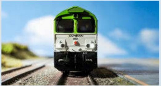
Bilder 21 + 22 Stirnbeleuchtung links für Deutschland und die Niederlande. Nur zwei Lampen sind in Belgien einzuschalten.
