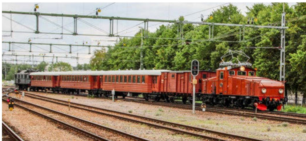
Der Sonderzug nach Avesta-Krylbo nochmals bei der Ausfahrt mit SDJ Hg 504 und der SJ P 27, einer 2' B 2'-Stangenlokomotive von ASEA/Falun aus dem Jahre 1914.
