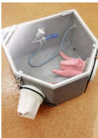
Strahlkabine Nummer 2. Nun sind die Eingriffsöffnungen bedeutend bequemer angeordnet.
