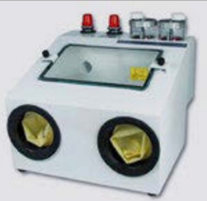
Professionelles Sandstrahlgerät für die Dentalindustrie (links) sowie eine Sandstrahlpistole im Detail.
