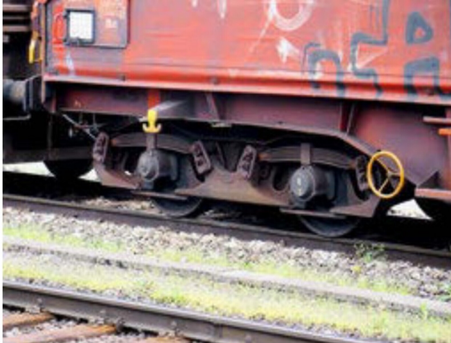
Detail des Drehgestells eines Shimmns. Man beachte die staubige Erscheinung des Untergestells.
