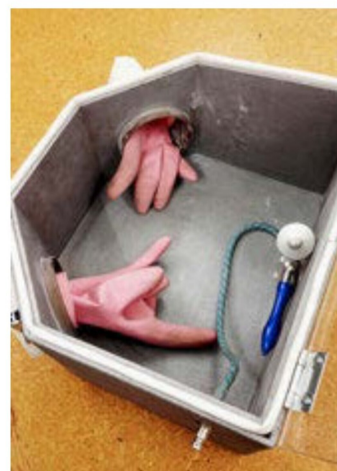
Am unteren Bildrand erkennt man den Adapter für die Druckluft-Schnellkupplung.
