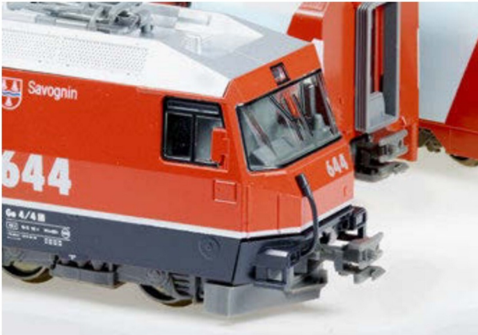
Die vorbildnahe Kurzkupplung an Lokomotive und Wagen...
