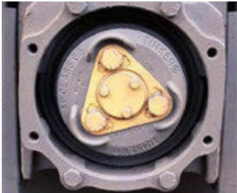
Bild 6 An amerikanischen Güterwagen als Standard kommen auch Achslager der «Timken Company» mit Hauptsitz in Canton, Ohio bei der Class 59 zur Verwendung.
