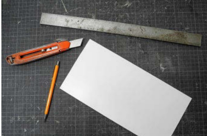
PVC-Hartschaumstoff lässt sich mit einfachsten Werkzeugen gut bearbeiten.
