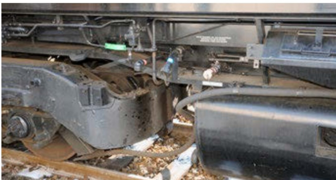
Bild 29 Massiv ist der gegossene Rahmen des Drehgestells.
