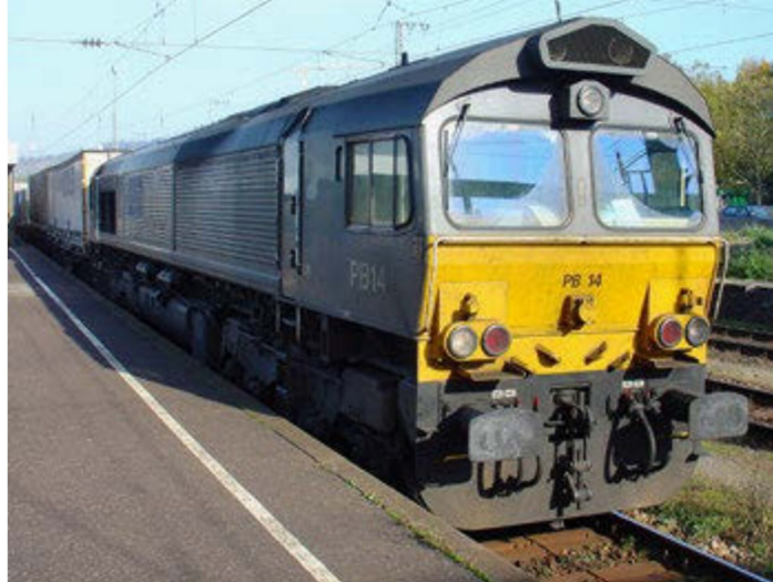
Bild 21 Frontpartie der DLC PB 14: Zurrhaken zwischen den Frontleuchten und seitlich am Rahmen ermöglichten eine gesicherte Überfahrt über den Atlantik.
