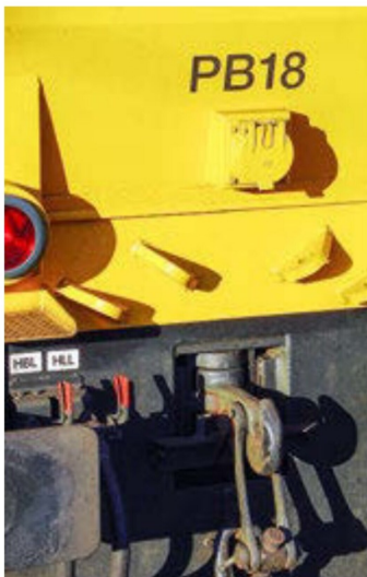
Bild 22 Zurrhaken bei der PB 18.
