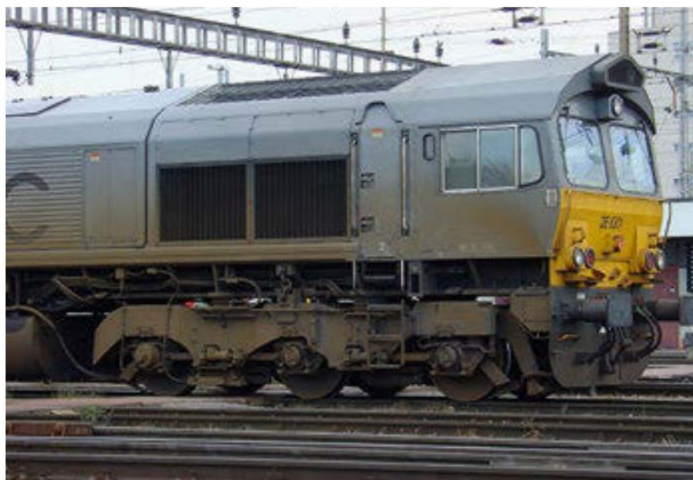
Bild 19 Kompletzt überzogen von einer Rost-/Schmutz-Patina ist das wuchtige HTCR-E Drehgestell der PB 03.
