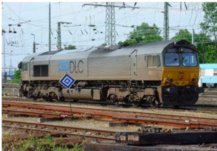
Bild 18 «DLC» PB 03 im Bereich des Gleisfelds der nördlichen Ausfahrt aus dem Badischen Bahnhof Basel. An den verschmutzten Drehgestellen heben sich die Leitungen kontrastreich ab.
