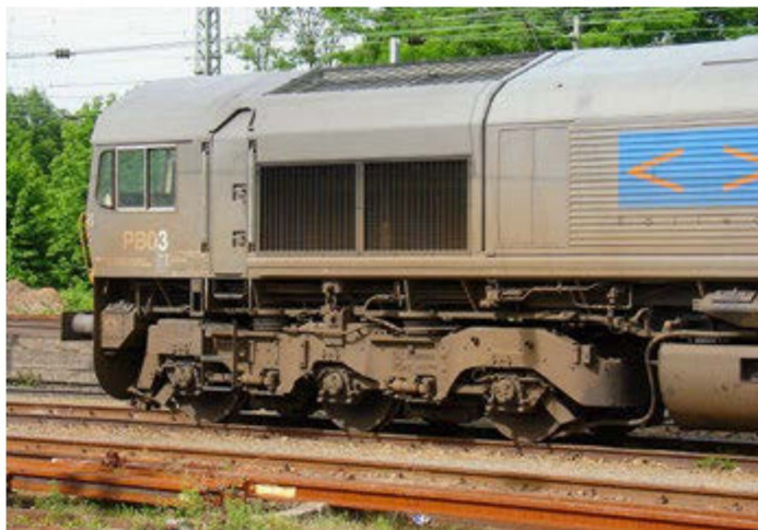
Bild 19 Kompletzt überzogen von einer Rost-/Schmutz-Patina ist das wuchtige HTCR-E Drehgestell der PB 03.
