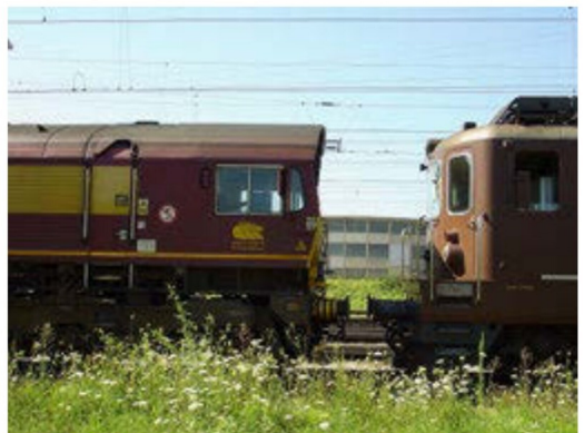
Bild 10 Optische Täuschung durch die verschiedenen grossen Lichttraumprofile. Doch tatsächlich stehen beide Lokomotiven auf dem gleichen Gleis.
