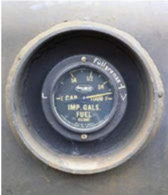
Bild 7 Tankanzeiger, bemerkenswert hier die Ergänzung auf Deutsch!
