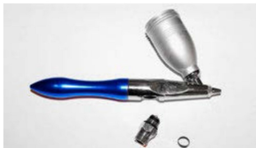
Mit einem einfachen Gummiring lässt sich aus dem Anschlussnippel ein Ventil herstellen, das nach dem gleichen Prinzip wie ein Veloschlauch-Ventil arbeitet.
