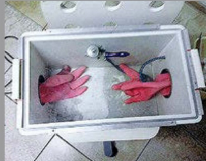
... war aber wegen der Anordnung der Eingriffsöffnungen für die Hände ergonomisch sehr ungünstig.
