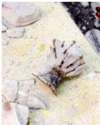
Guss gelungen! Die Messingteile müssen noch aus dem Gips ausgebrochen, vom Stamm abgesägt und nachbearbeitet werden.
