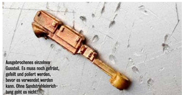
Ausgebrochenes einzelnes Gussteil. Es muss noch gefräst, gefeilt und poliert werden, bevor es verwendet werden kann. Ohne Sandstrahleinrich-tung geht es nicht!
