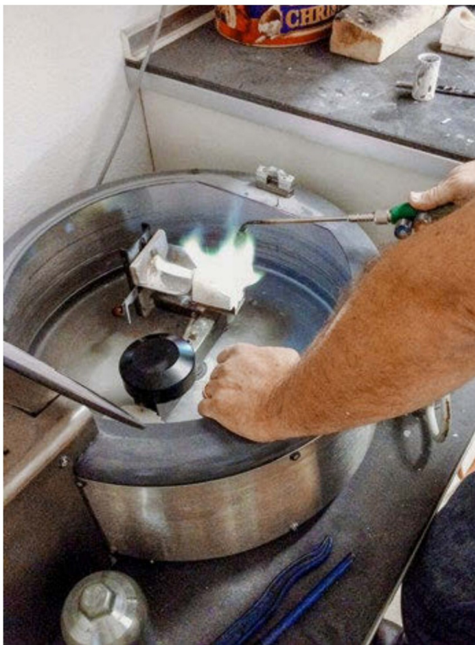
Im Schmelztiegel werden die Messingstücke (Abfälle aus der Werkstatt) auf über 1000 °C erhitzt. Dies geschieht direkt in der Schleudergussmaschine, um ein zu rasches Abkühlen des flüssigen Metalls möglichst zu verhindern.
