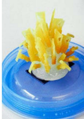
Für den Schleuderguss werden Dutzende von einzelnen Wachslingen zu einem, an moderne Kunst erinnernden Wachsbaum zusammengeklötet.
