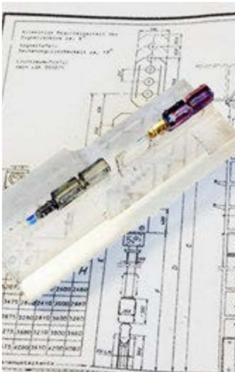
Zwei Urmodelle für die Schaltkästen aus Plexiglas, mit Filzstift eingefärbt, so sind sie besser sichtbar.
