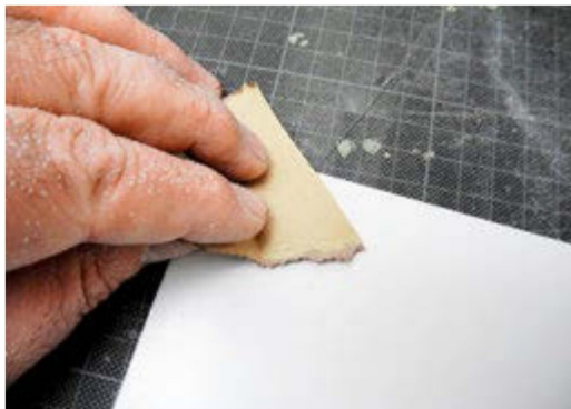
Oberflächenvorbereitung mit Schleifvlies ...
