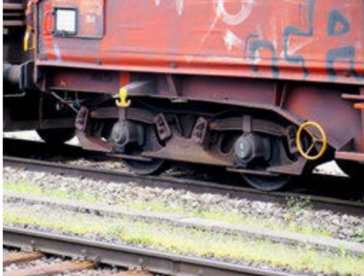
Detail des Drehgestells eines Shimmns. Man beachte die staubige Erscheinung des Untergestells.
