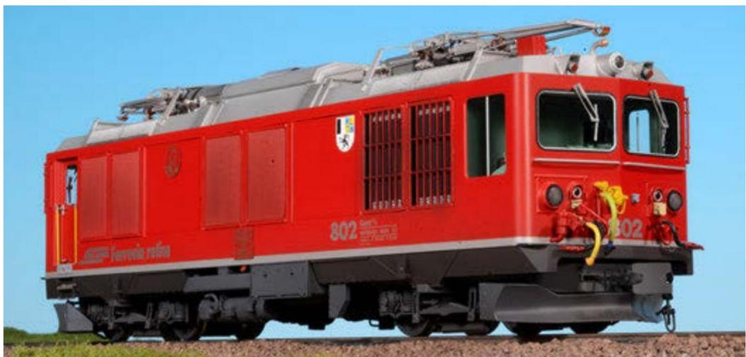
Stammnetzes der RhB. Erstmals sind durch Model Rail aber auch mit kleinen Servos ausgerüstete Einholmstromabnehmer installiert worden, die sich heben und senken lassen. Im gehobenen Zustand sind die Stromabnehmer frei beweglich und passen sich der Fahrdrähterlage in der Höhe beliebig an.
