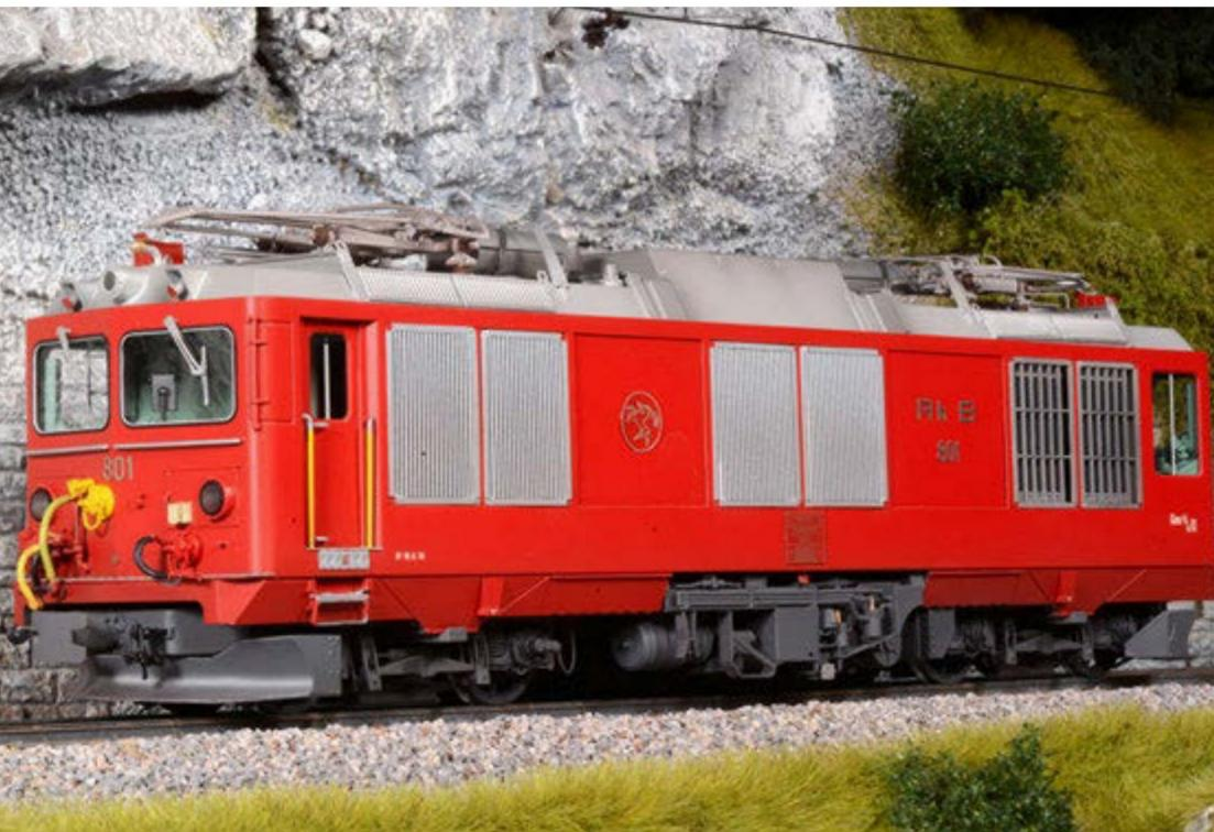
In den 1960er-Jahren stand bei der RhB allgemein, für die Berninalinie speziell, der Ersatz von Fahrdräht unabhängigen Fahrzeugen an, die im Störungsfall und bei der Schneeräumung bei ausgeschalteter Fahrleitung als Traktionsmittel verwendet werden sollten. Die Überlegungen führten zur Lösung in Zweikraftlokomotiven, die auch im Regelverkehr auf der Berninalinie elektrisch mit den damals neuen Triebwagen
