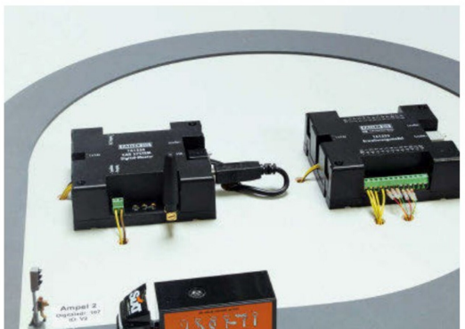
Zur Lichtsteuerung der Ampel wird ein Erweiterungsmodul angeboten.
