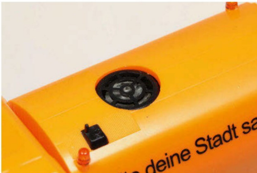
Merkmale des Faller Car Systems Digital 3.0: Ultraschallkapsel ...
