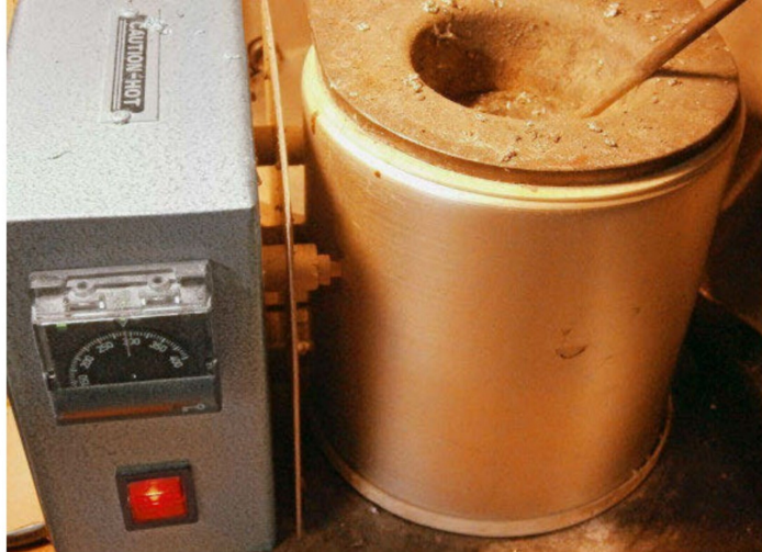
Der elektrisch beheizte und thermostatisch geregelte Schmelztiegel erhitzt das Weissmetall auf 290 °C.
