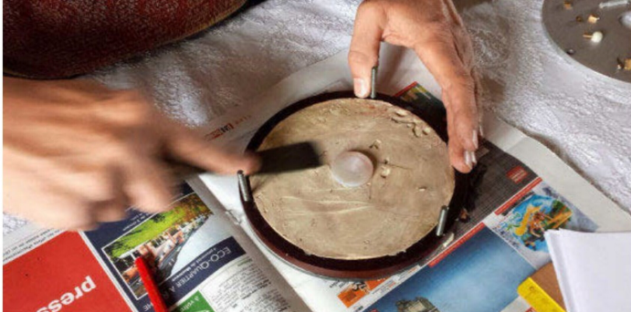
Beginnen wird bei der Formherstellung mit einer temporären Schicht Knetmasse (Plastilin).
