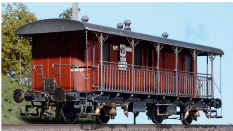
Gotthardbahn Postwagen mit Seitengang: Dadurch konnte er auch mitten im Zug eingereiht werden.
