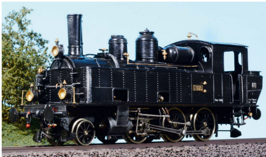
Die Ec 3/4 181 bis 192 der GB waren ein Gemeinschaftswerk der Maschinenfabrik Esslingen und der SLM. Einzelne Maschinen blieben bis 1933 in Betrieb.
