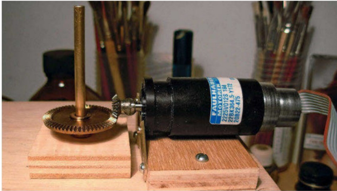
Der Antrieb erfolgt mit einem Präzisionsmotor über zwei Kegelzahnräder.
