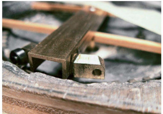
Die im Text beschriebenen Messingklötzchen zur Aufnahme der Kugellager.
